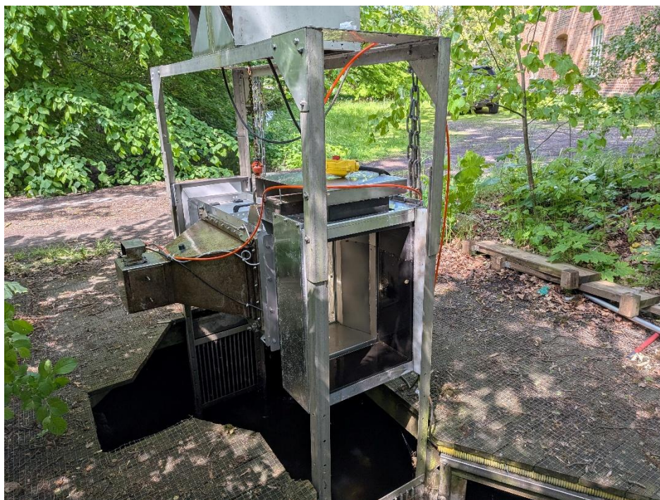
Figur 2. TiVA FC ersätter den tidigare VAKI RWC. Till vänster i bild syns kamerakonen där de båda kamerorna för storleksmätning och videoinspelning finns.
