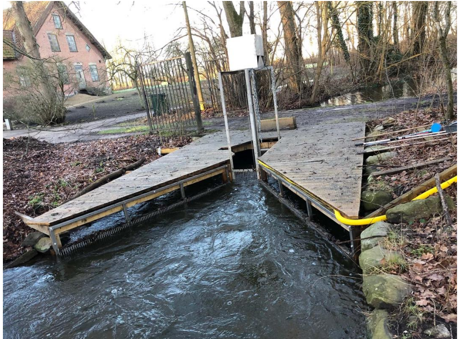
Figur 4. Bild som visar läge för fiskräknaren i en äldre kvarnränna vid Håstadmölla.
