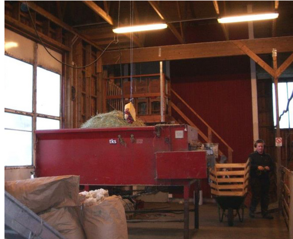
Stationär balrivare. Porten kan stängas bakom den vilket gör att det inte drar in den vägen.
