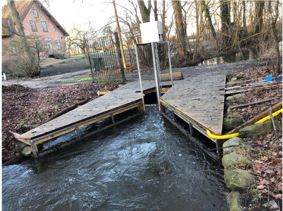
Figur 5. Bild som visar läge för fiskräknaren i en äldre kvarnränna vid Håstadmölla.
